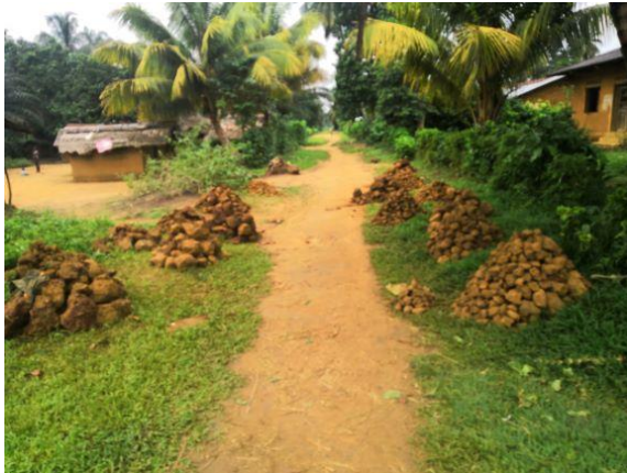
Des tas de grès polymorphe servant de moellons et concassés à Kiri et extrait par les exploitants artisanaux
